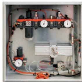
Metal Work steht zur Verfügung, maßgeschneiderte Bausätze zu liefern, sowohl als einzelne Komponenten, als auch als komplett, zusammengebaute und geprüfte elektro-pneumatische Einheiten.
